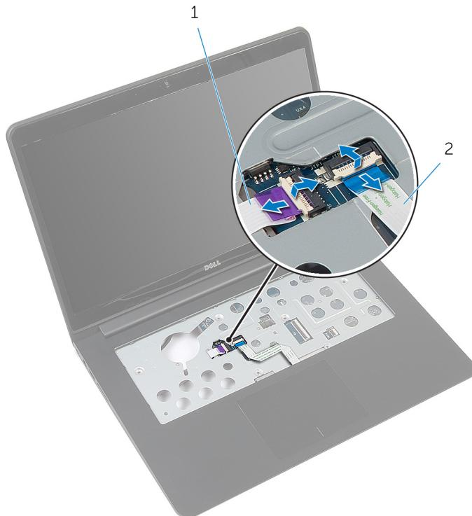
**1** kabel ploče sa svjetlima
