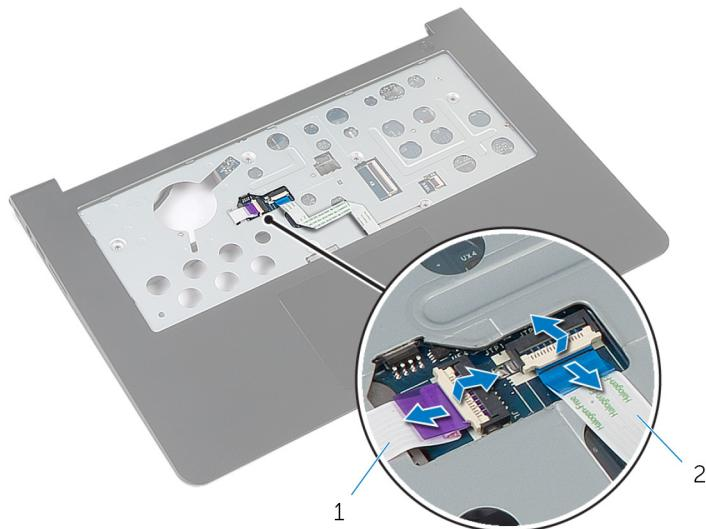
1 kabel ploče sa svjetlima
